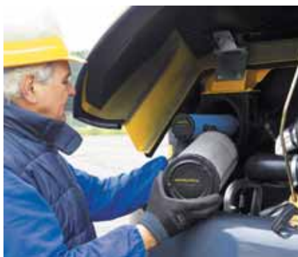
Capot arrière pour contrôle rapide des éléments du moteur et accès aux endroits d'entretien depuis le niveau du sol
