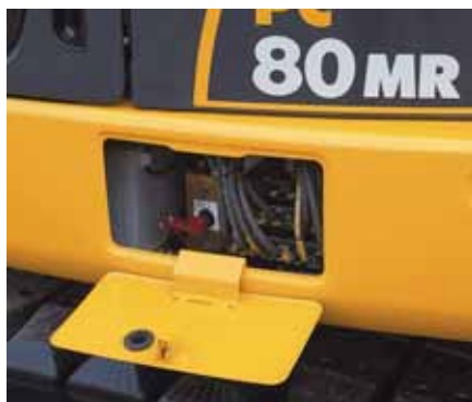
Coupe circuit de l'installation électrique en standard
