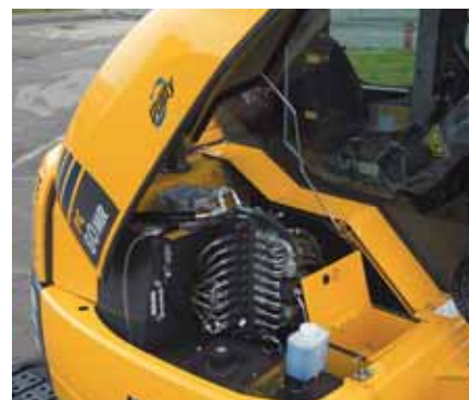
Capot droit pour accès aisé aux distributeur principal, réservoir à carburant, réservoir d'huile hydraulique et boîte à outils
