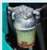
Préfiltere à carburant avec décanteur d'eau intégré
