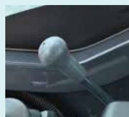
Le levier de lame a une commande hydraulique pilotée pour plus de précision.
